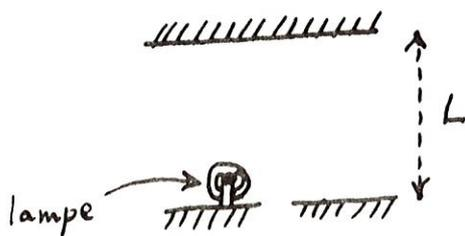
Elle est composée de deux miroirs, séparés d'une distance  $L$ , les deux surfaces réfléchissantes étant dirigées l'une vers l'autre. Un de ces miroirs a un petit trou ; une lampe est placée sur ce miroir à l'intérieur de l'ensemble.
