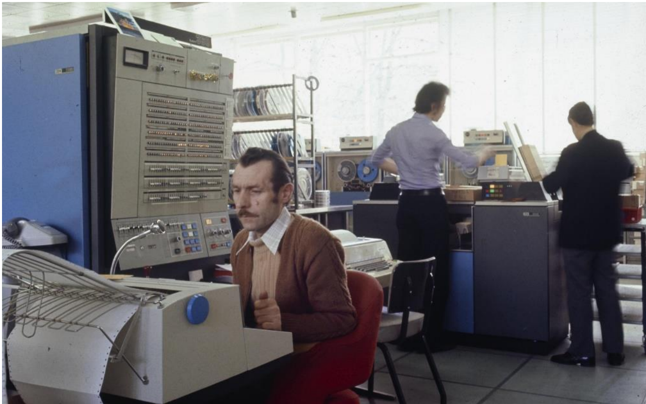
Figure 63 : L'IBM 360/65 de Meudon et son pupitre de commande. A l'arrière plan on distingue au fond les dérouleurs de bande magnétique et le lecteur de cartes perforées à droite, avec un gros paquet de cartes en cours de lecture. Crédit OP.
