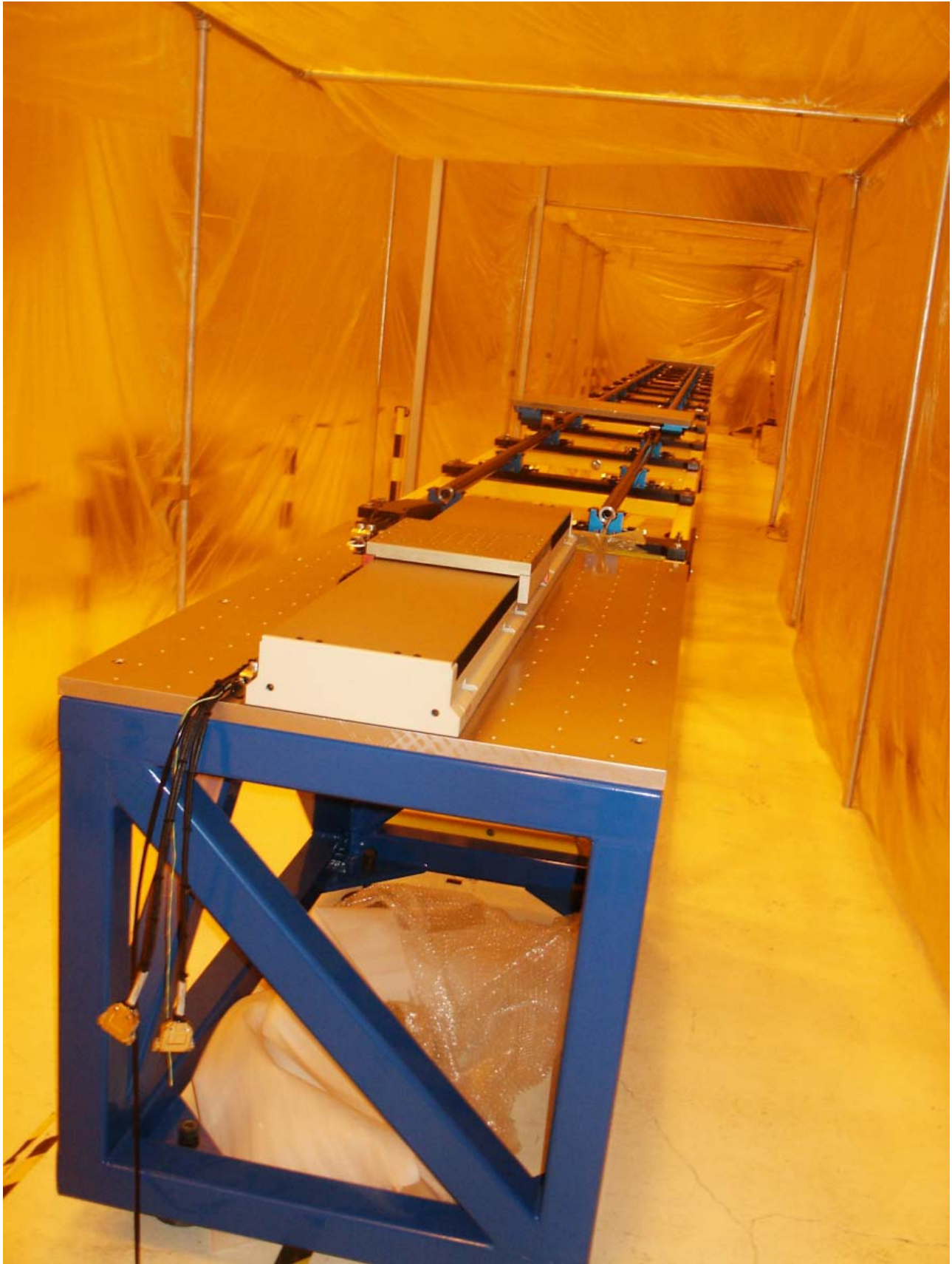
Figure 6.3.6 : Photo de la ligne à retard sans les systèmes opto- mécaniques (table Aerotech au premier plan)
