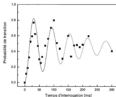
FIGURE 2 – oscillations de Rabi amortie
