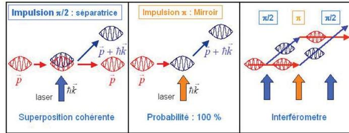
FIGURE 1 – Schéma d'un interféromètre atomique
