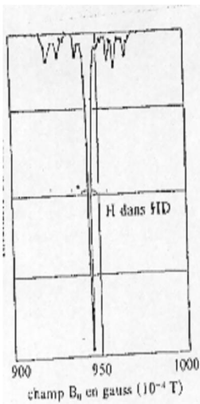
Rabi opérait sur un faisceau de molécules HD à pression ( $p < 5 \cdot 10^{-3}$  mm Hg) et basse température  $T = 78^\circ\text{K}$ . Le champ tournant était  $B_1 = 10^{-4}$  T,  $\nu = 4$  MHz, et on faisait varier le  $B_0$ . La courbe de résonance du proton est montrée ci-dessus.
