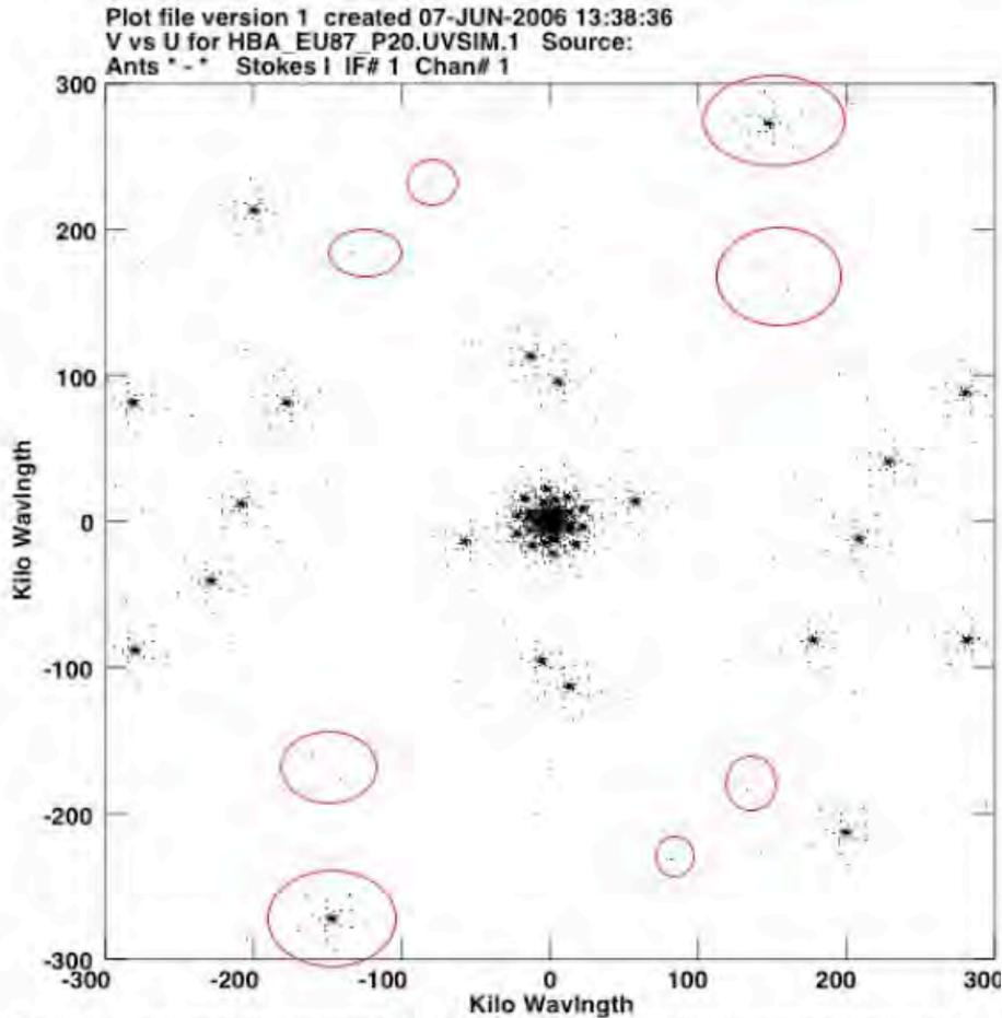
Figure 4 : simulation de couverture du plan u-v de LOFAR incluant les stations prévues en Allemagne et au Royaume-Uni. En rouge l'apport de la station de Nançay. Par intégration sur plusieurs heures, et grâce à la rotation terrestre la synthèse améliore encore la couverture du plan. Couverture instantanée pour H.A.=0 (limitée à une élévation de 45°) pour une déclinaison de 20° à 150 MHz.
