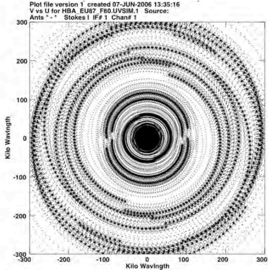
Figure 5 : Couverture du plan u-v pour une déclinaison de 80°, utilisant la rotation de la Terre pour une intégration pendant 8 heures.
